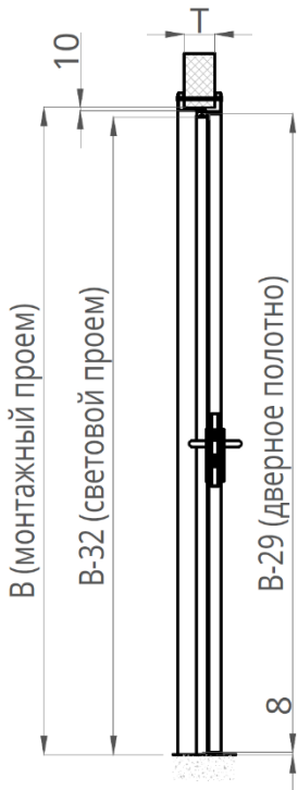
Рисунок 22. Разрез 2-2. Крепление рамы в обхват без порога
