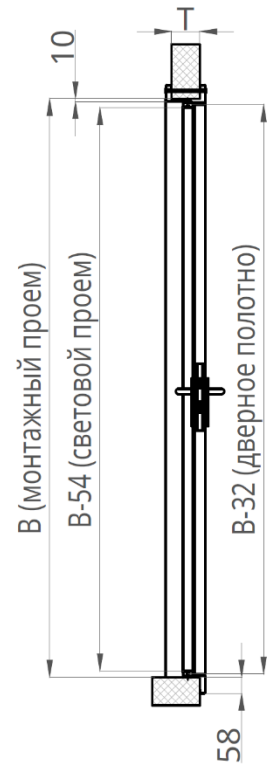
Рисунок 24. Разрез 4-4. Крепление рамы в обхват с порогом 60
