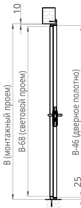
Рисунок 10. Разрез 3-3. Крепление угловой рамы ТДО с порогом 40
