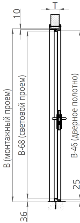
Рисунок 23. Разрез 3-3. Крепление рамы в обхват с порогом 40
